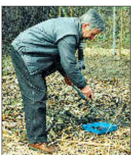
Rudolf Behm bei der Entnahme von Bodenproben mit dem Rillenbohrstock im Bad Freienwalder Total-Mulch-Garten.
