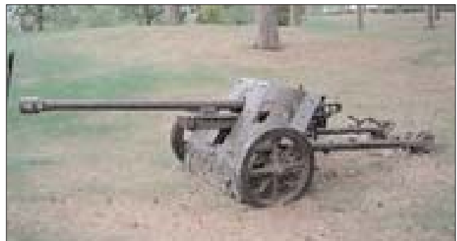
Panzerabwehrkanonen (auf dem Foto eine Pak 38, Kaliber 50 mm) gehörten zur Produktion der Ardelt-Werke. 1942 wurden in Eberswalde pro Monat 600 Pak hergestellt.
